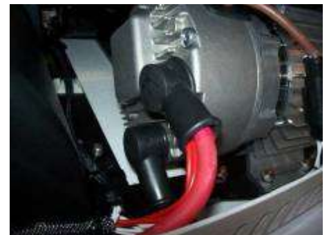
3. Remettre le capuchon en place. Répéter les opérations 1 et 2 sur la borne – du moteur avec les fils et câble de masse (noirs)
