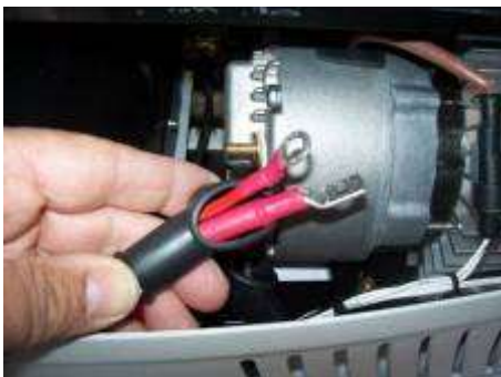
1. Dévisser les deux écrous de la borne + du moteur. Faire passer le câble rouge de raccordement à l'intérieur du capuchon
