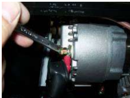
2. Revisser les écrous sur les deux cosses rondes des fils et câbles positifs (rouges) et la rondelle éventail
