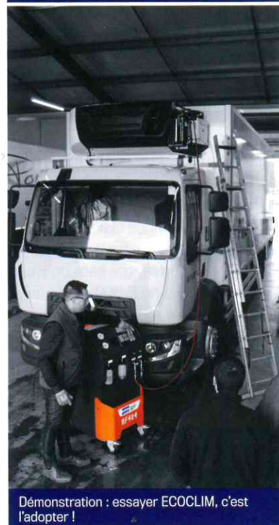
Conservant leurs propriétés fonctionnelles, les réfrigérants recyclés par les centrales ECOCLIM RF404 et RF452 sont réinjectés dans les groupes.
